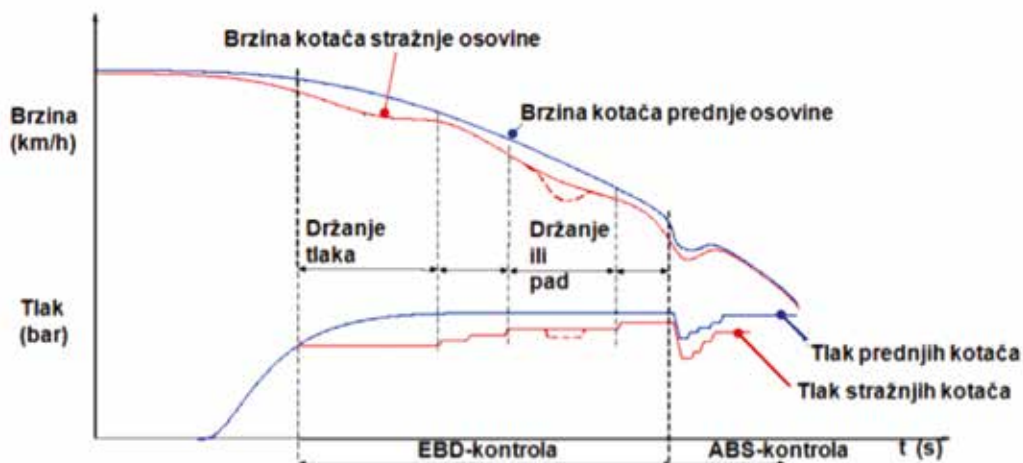
Slika 7.44. EBD funkcija raspodjele kočne sile
