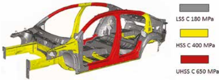
Slika 10.48. Raspodjela čelika u strukturi jedne monokok karoserije (Spottrack 2017)
