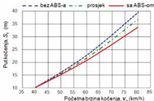
Slika 7.16. Put kočenja vozila u ovisnosti o početnoj brzini vozila
