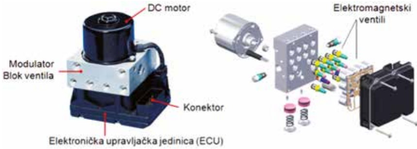
Slika 7.21. Sastavnice hidraulično-elektroničke upravljačke jedinice (HECU), MK70 (ABS, EBV, MSR, ASR)
