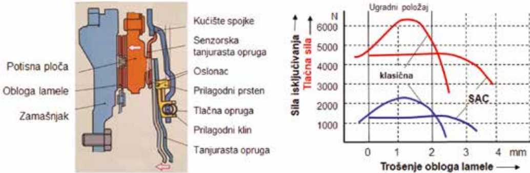
Slika 6.15. Promjena tlačne sile na potisnu ploču uslijed trošenja obloge
