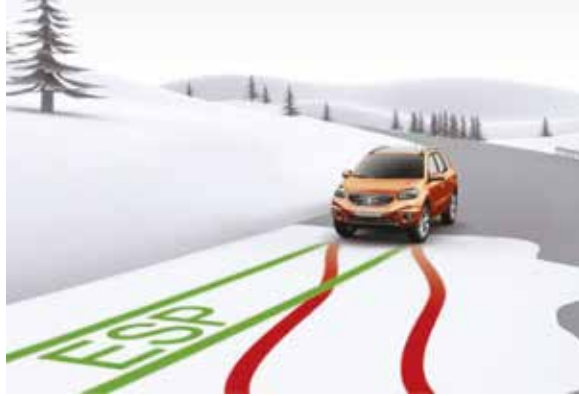
Slika 5.20. Držanje pravca pri nailasku vozila na poledicu s uključenim i isključenim ESC-sustavom (ESP- Bosch)
