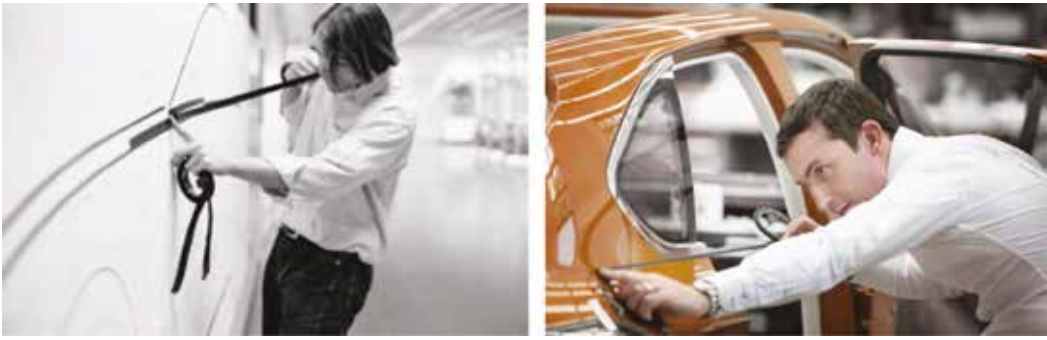
Slika 11.11. Iscrtavanje trakama vanjskih linija (BMW)
