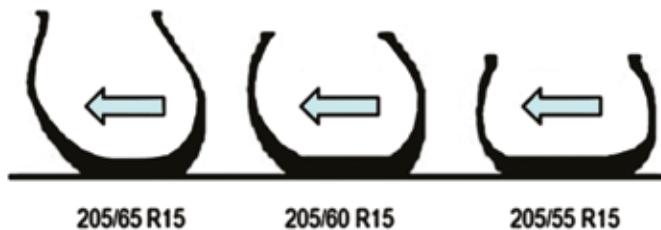
Slika 2.11. Deformacija standardnog i niskoprofilnog pneumatika u zavoju
