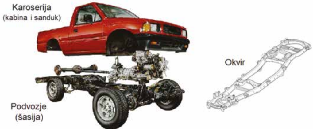
Slika 10.2. Klasična odvojena karoserija i podvozje komercijalnog vozila (Pick-up)
