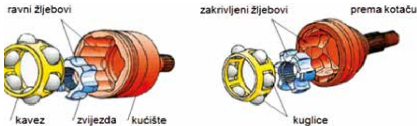
Slika 6.109. Kuglasti zglob tipa Weiss (lijevo) i kuglasti zglob sa zakrivljenim žljebovima (desno)
