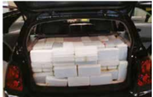
Slika 11.17. Simulacija i mjerenje kapaciteta prtljažnika (BMW)
