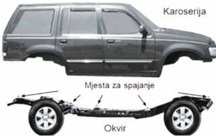
Slika 10.3. Klasična karoserija i okvir SUV vozila
