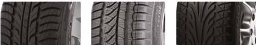
Slika 2.10. Dezen gazne površine: simetrični, asimetrični, V-oblik
