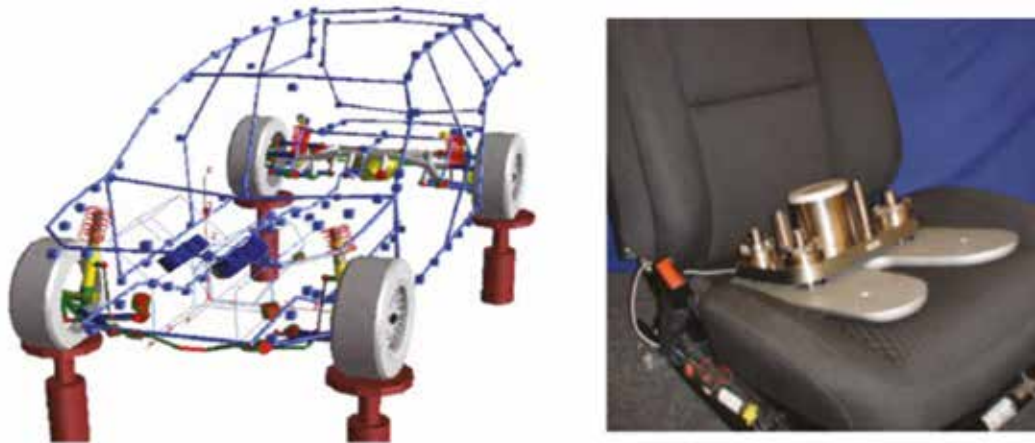
Slika 12.4. Multibody vibracijska simulacija i vibracijska lutka (desno)
