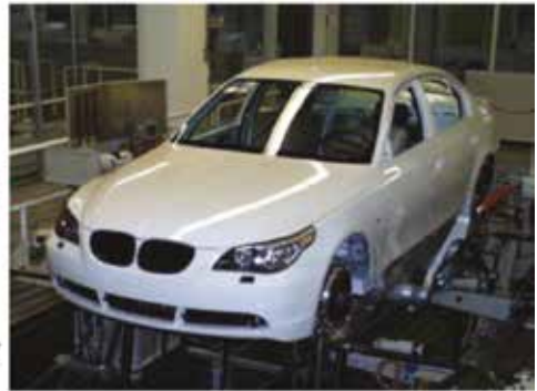
Slika 10.47. Ubrzano testiranje karoserije na zamor (BMW)
