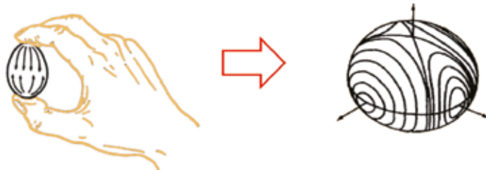
Slika 10.40. Čvrstoća prostora za putnike (citadel) u obliku jajeta ili kugle
