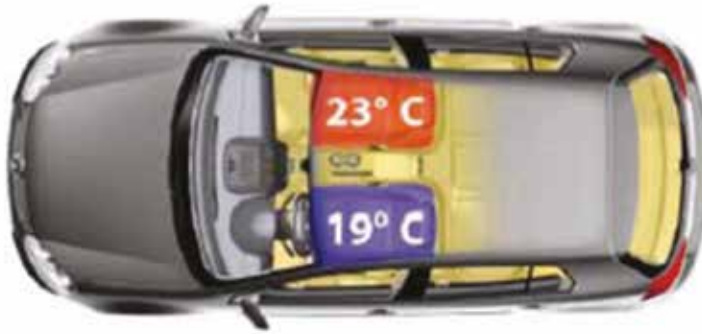
Slika 12.32. Klimatizacijske zone kabine
