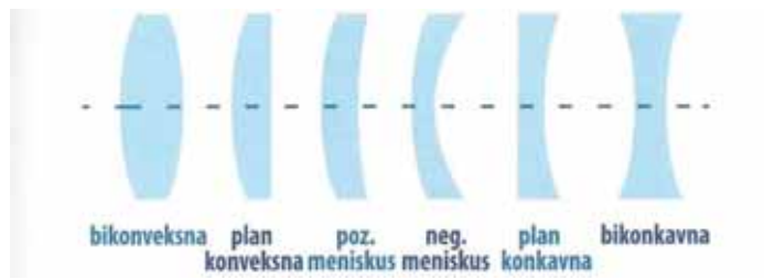
Slika 6. Razni oblici tankih leća, sastavljenih od dva sferna dioptra.
